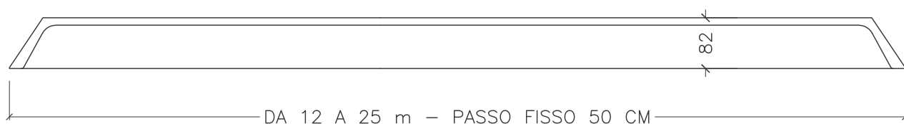
SEZIONE LONGITUDINALE CON TESTATE CHIUSE
